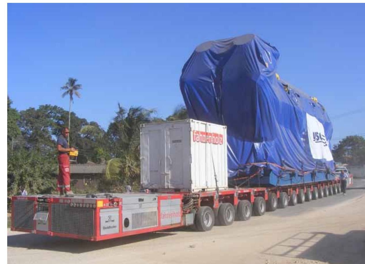
Som projektspediter har H.H. Danship bl.a. forestået transporten af fem motorer på hver 320 ton fra Italien til en slutdestination i Kenya via Mombasa. Motorerne skulle benyttes på et kraftværk. Alt udstyr til indlandstransporten blev medbragt på skibet fra Italien. På det lille billede illustreres nogle af de problemstillinger, som på forhånd skulle afklares, inden landevejstransporten fra Mombasa til slutdestinationen. Fotos: H.H. Danship
