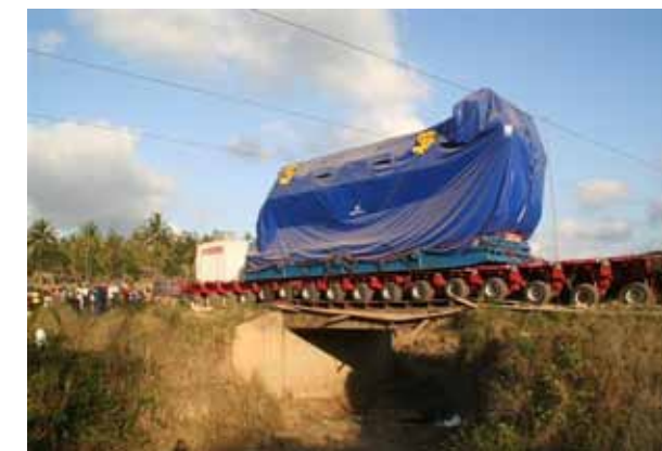
Som projektspediter har H.H. Danship bl.a. forestået transporten af fem motorer på hver 320 ton fra Italien til en slutdestination i Kenya via Mombasa. Motorerne skulle benyttes på et kraftværk. Alt udstyr til indlandstransporten blev medbragt på skibet fra Italien. På det lille billede illustreres nogle af de problemstillinger, som på forhånd skulle afklares, inden landevejstransporten fra Mombasa til slutdestinationen. Fotos: H.H. Danship
